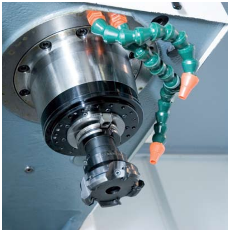
Vřetenová jednotka 10 000 min -1 // Jednostka wrzeciona 10 000 min -1
